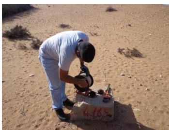
PHOTO 5: MESURE PIEZOMETRIQUE EXTERNALISEE
